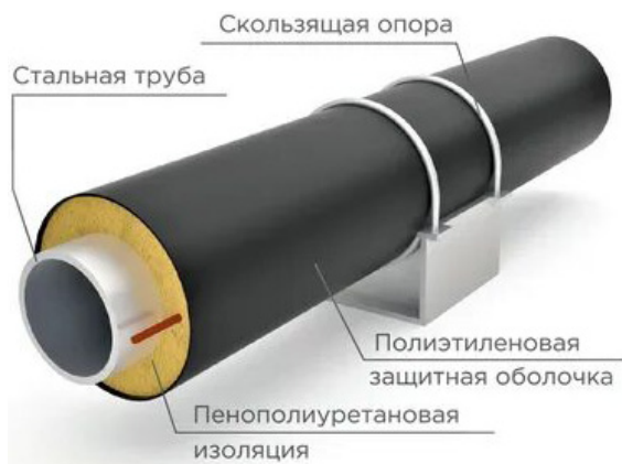
Рисунок 1 – Тепловая изоляция на трубах ЦТП
