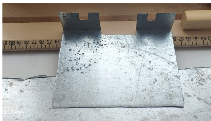
Рисунок 3 – Защитный экран для отражения излучения лам накаливания
