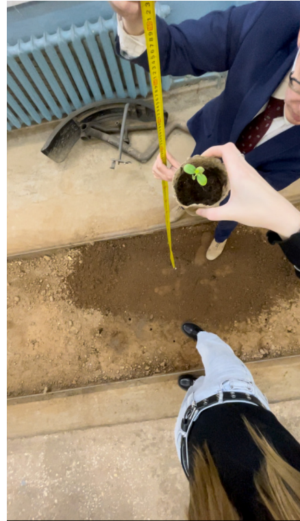
Рисунок 8 – Сброс стаканчиков с рассадой на мягкую почву
