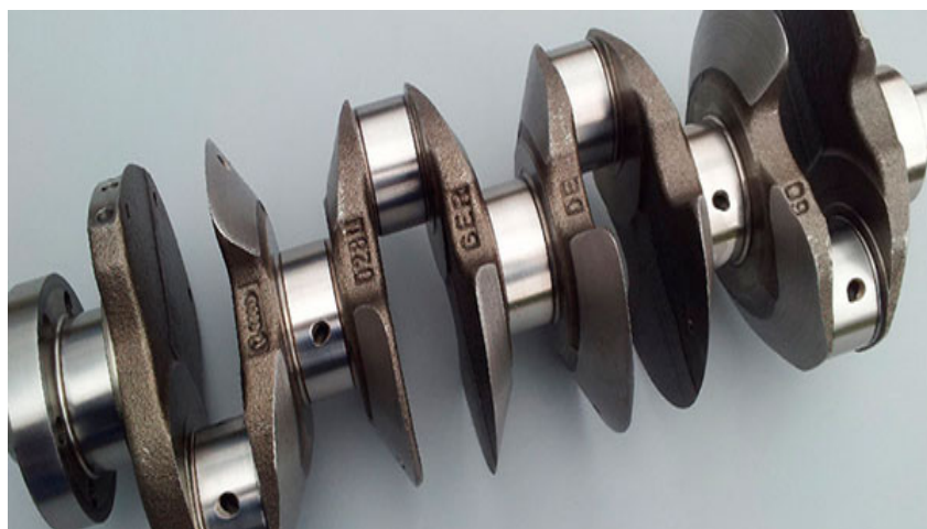
Рисунок 2 – Коленчатый вал после проведения шлифовки поверхностей
