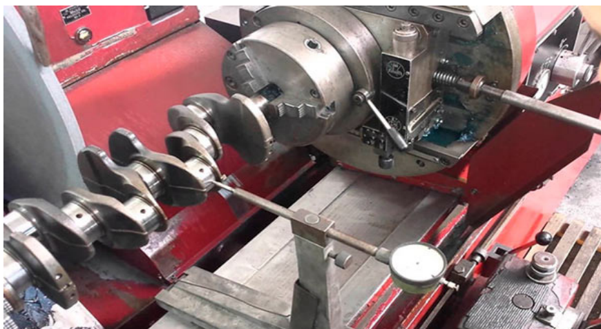
Рисунок 1 – Проверка биения вала индикаторной головкой
