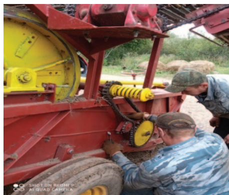
Рисунок 5 – Варианты исполнения экспериментальных натяжных устройств: а, б – натяжение цепей; в – натягивающе-отводящее устройство
