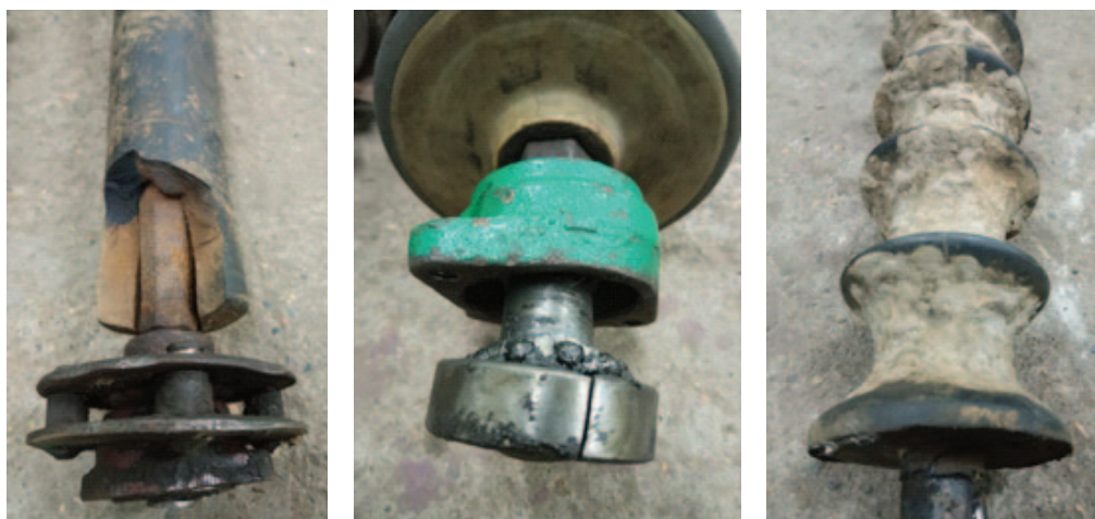
Рисунок 2 – Распространенные дефекты рабочих органов сортировки
