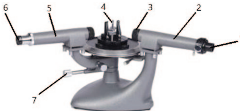
Рисунок 2 – Устройство двухтрубного спектроскопа:
