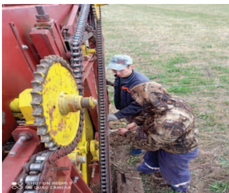
Рисунок 5 – Варианты исполнения экспериментальных натяжных устройств: а, б – натяжение цепей; в – натягивающе-отводящее устройство
