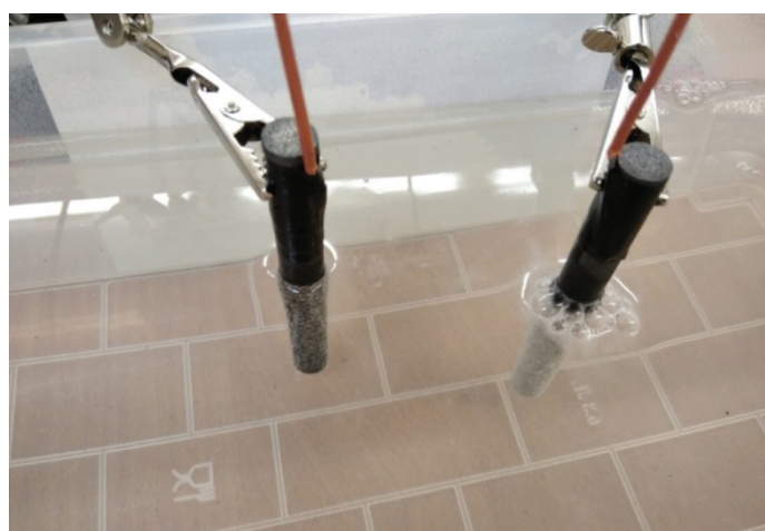
Рисунок 4 – При проведении опытов на электродах выделялся кислород и водород
