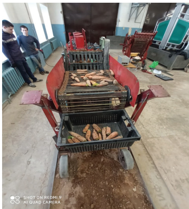
Рисунок 2 – Тяговые испытания экспериментального малогабаритного морковуборочного комбайна
