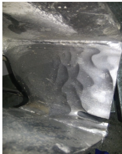
Рисунок 3 – Износ лопасти барабана дробилки в производственных условиях
