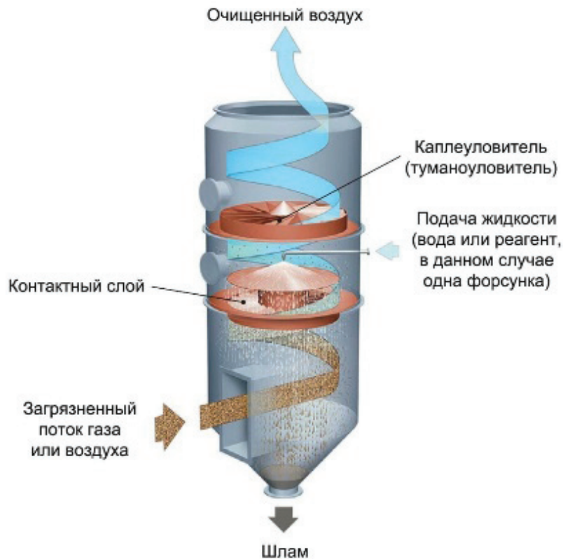
Рисунок 1 – Центробежный скруббер с падающей пленкой (fallingfilmscrubber)
