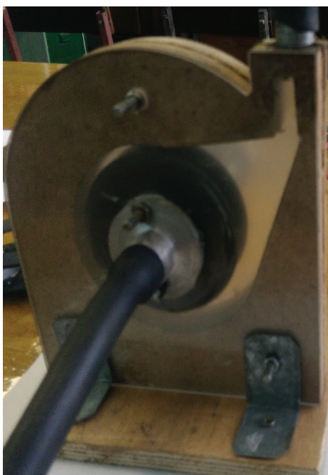
Рисунок 1 – Масштабированная модель молотковой дробилки зерна ДКР – 5М
