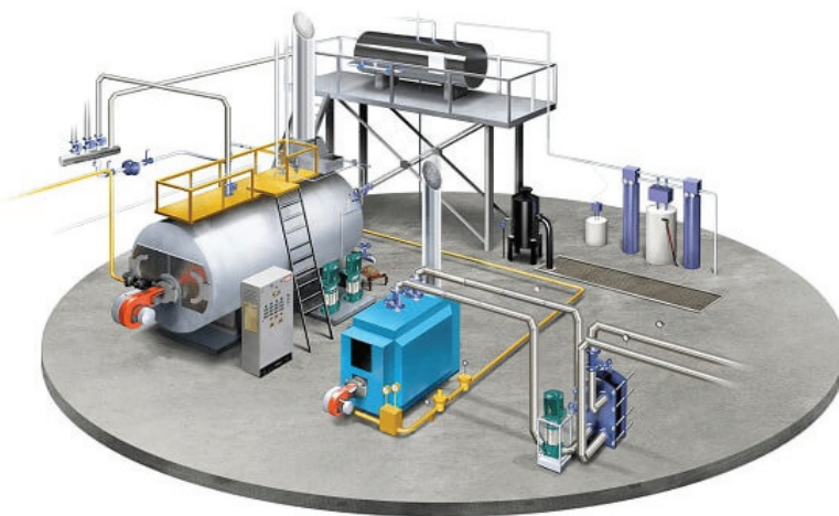
Рисунок 1 – Основное оборудование котельной
