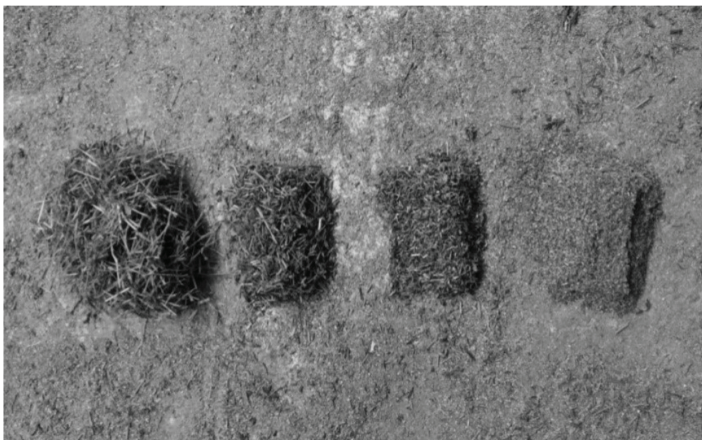
Рисунок 1 – Результат анализа монокорма при помощи «Пенсильванского сита»
