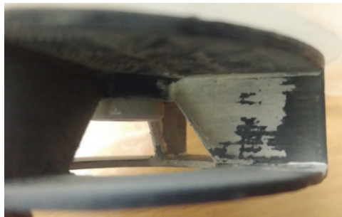
Рисунок 2 – Износ окрашенной поверхности лопасти 3D модели барабана
