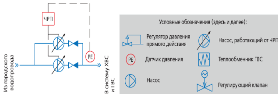
Рисунок 1 – Параллельная схема с двумя насосами
