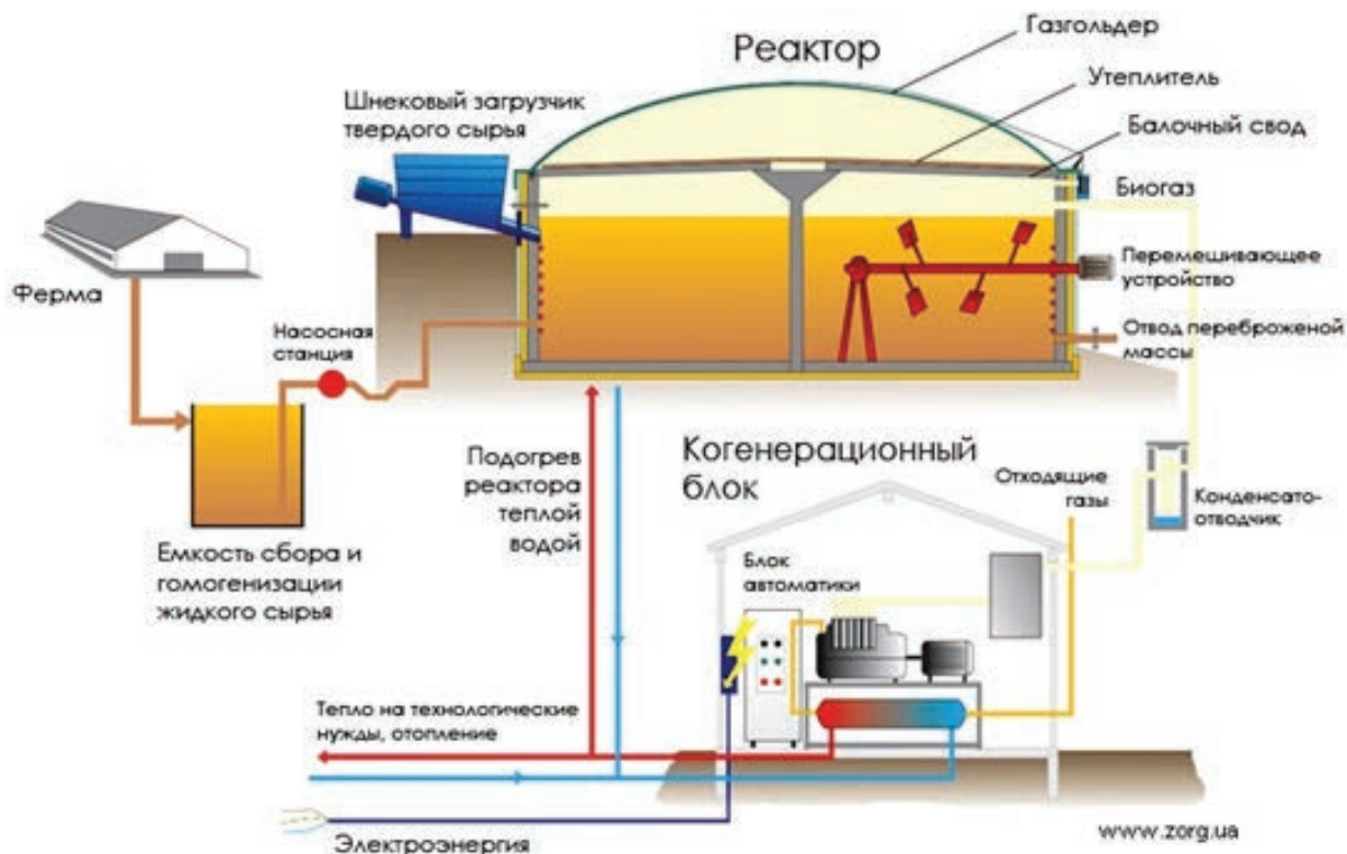
Рисунок 3 – Принцип работы биогазовой установки
