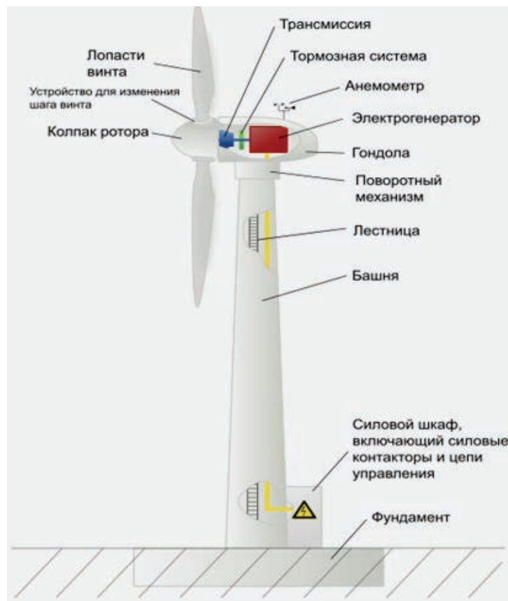
Рисунок 1 – Общий вид ветрогенератора
