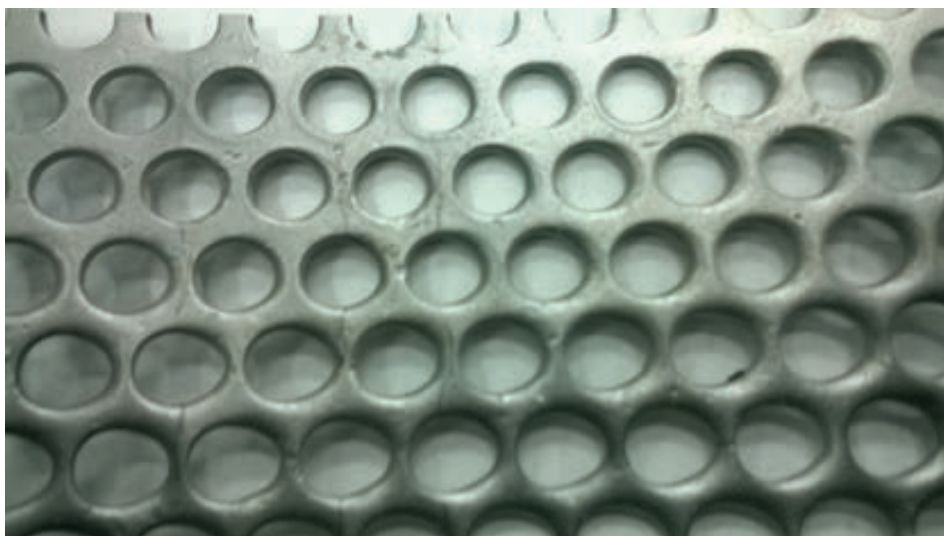
Рисунок 1 – Фрагмент изношенного решета
