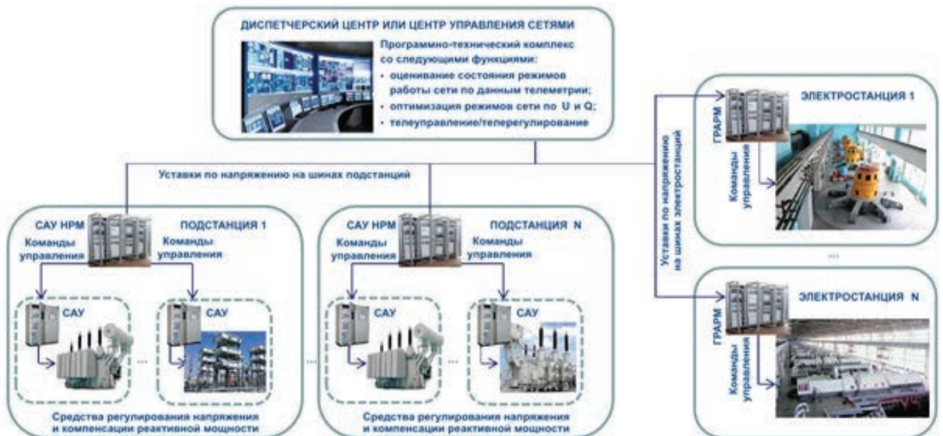
Рисунок 8 – Целевая схема иерархического регулирования напряжения в энергосистемах
