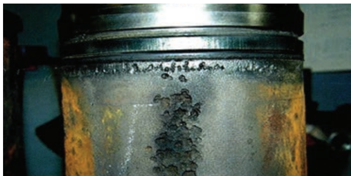
Рисунок 1– Кавитационный износ гильзы ДВС
