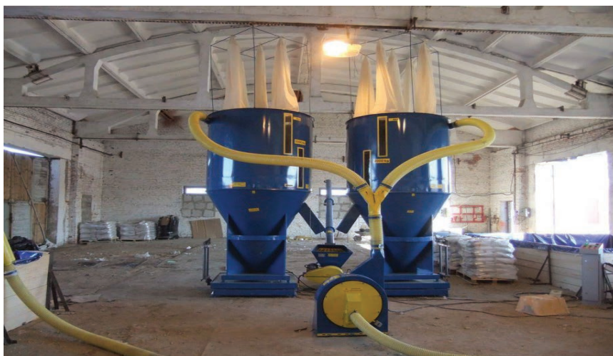
Рисунок 1 – Установка по приготовлению комбикорма АТМ-2
