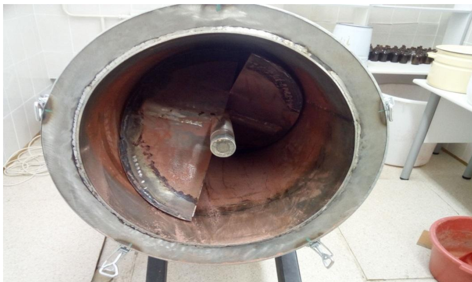
Рис. 2 – Вакуум в пределах 0,2...0,6 атм внутри барабана-смесителя обеспечивается вакуумным насосом, который необходим для отвода токсичных газов, получаемых при нагревании и смешивании компонентов
