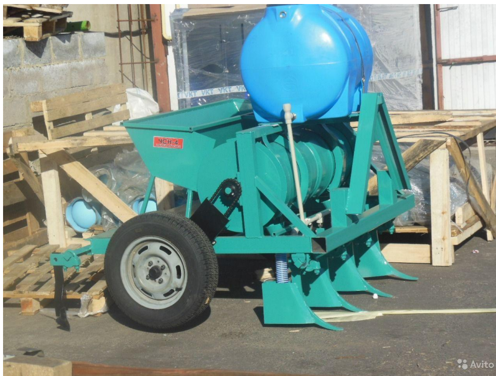
Рисунок 3 - Сеялка для чеснока ЧСН-4
