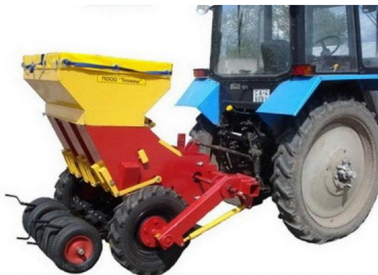
Рисунок 2 - Машина для посадки лука севка
