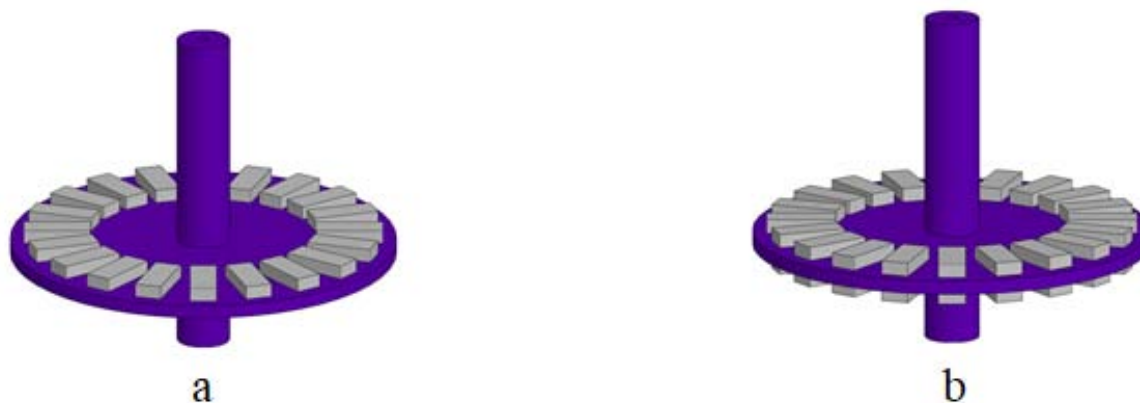
Рисунок 6 – Накладные постоянные магниты: а – с односторонним расположением; б – с двухсторонним расположением
