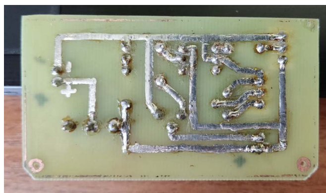
Рисунок 5 – Смонтированная плата драйвера (со стороны токопроводящих дорожек)
