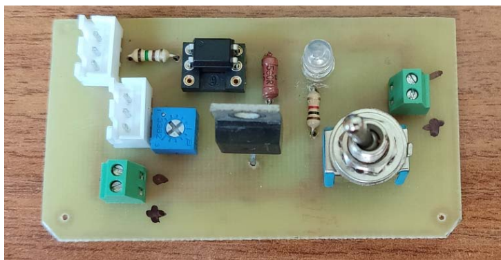
Рисунок 4 – Смонтированная плата драйвера
