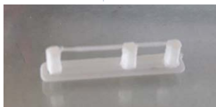
Рисунок 1 – Напечатанная модель с мостом в одну линию на расстояние 0,5 и 1 см
