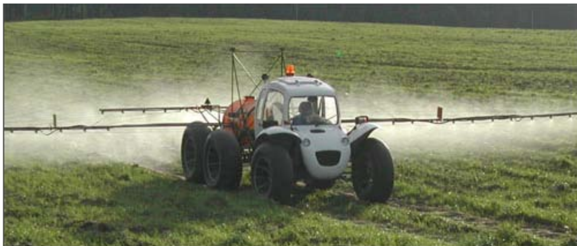
Рисунок 3 – Самоходный опрыскиватель «Роса»
