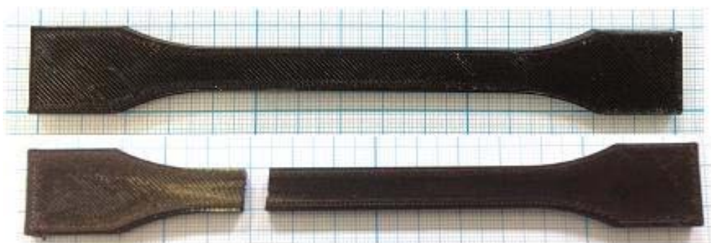
Рисунок 1 – Образцы на растяжении до и после испытания
