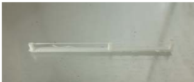
Рисунок 3 – Напечатанная модель с мостом в одну линию на расстояние 3 и 4 см
