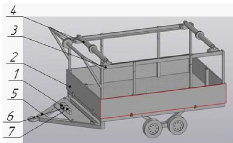
Рисунок 1 – Модель малогабаритной тележки с электроприводом: 1 – электропривод; 2 – тележка; 3 – стойка с рельсами; 4 – вал с опорами; 5 – зацепное устройство; 6 – редуктор; 7 – барабан
