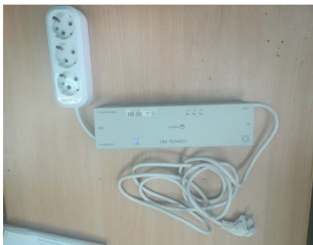
Рисунок 1 – Изображение устройства комбинированной защиты объектов информатизации «Соната-ПК1»
