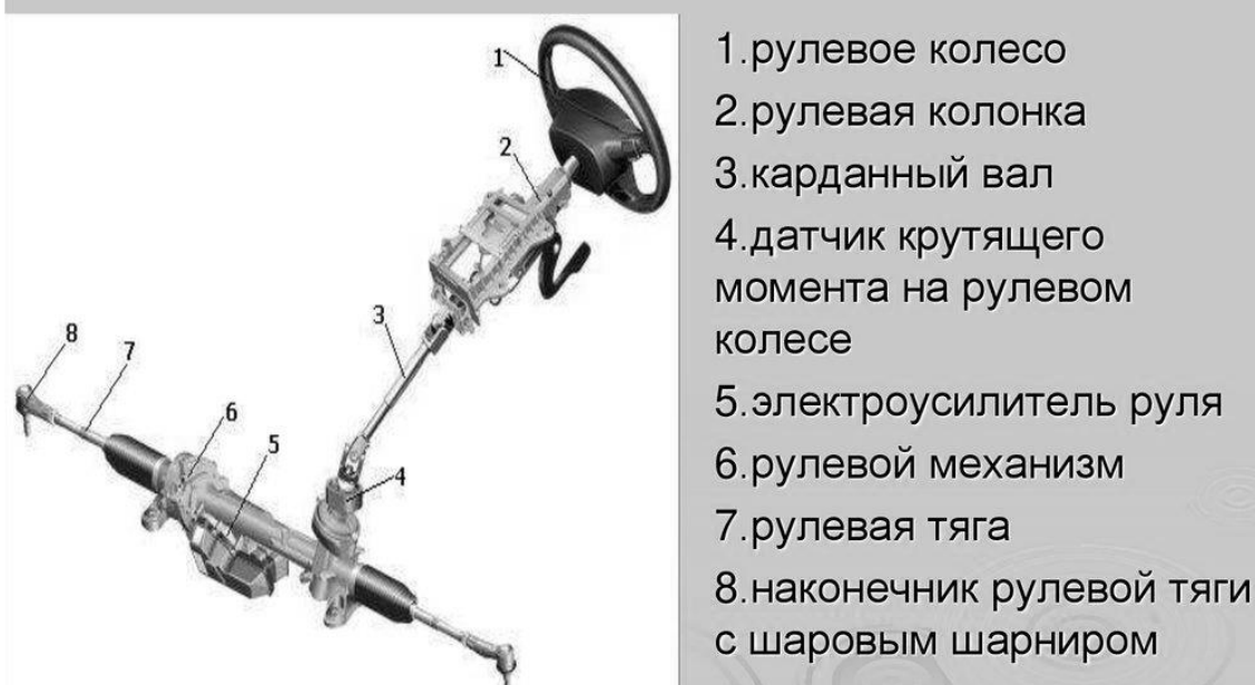
Рисунок 1 – Рулевое управление
