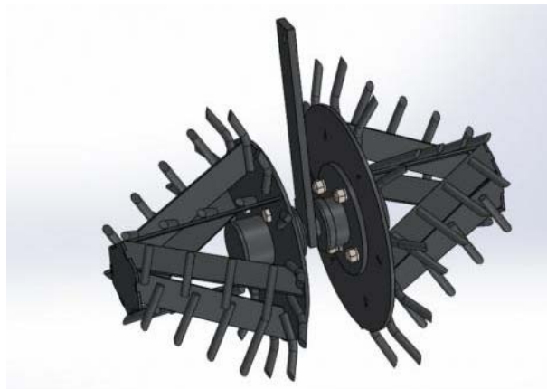
Рисунок 2 – Ротационный рыхлитель культиватора КОН 2,8А
