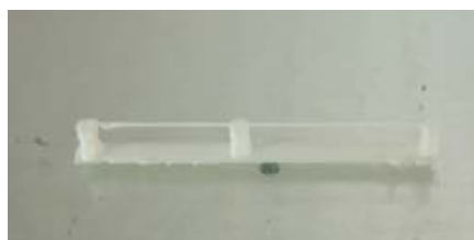
Рисунок 2 – Напечатанная модель с мостом в одну линию на расстояние 1,5 и 2 см
