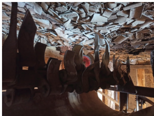
Рисунок 5 – Ротационный ботвоудалитель: а – вид спереди; б – рабочие органы
