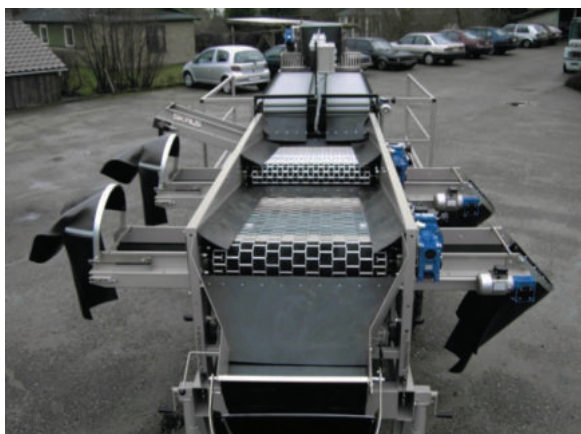
Рисунок 5 – Ленточные машины для калибровки овощей
