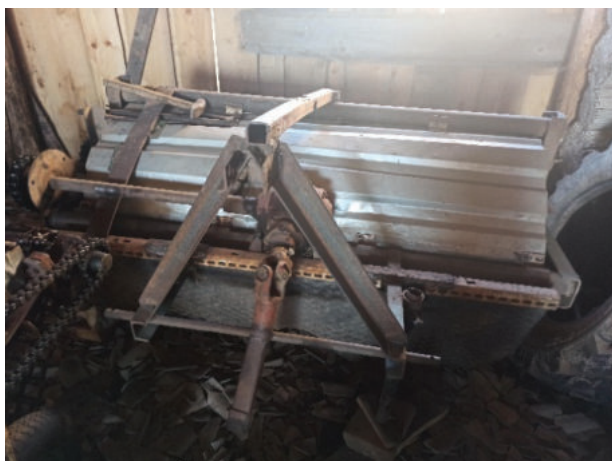
Рисунок 5 – Ротационный ботвоудалитель: а – вид спереди; б – рабочие органы
