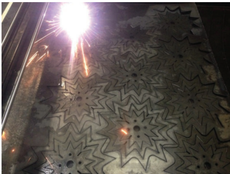
Рисунок 2 – Результаты автоматизированного раскроя металлических листов на идентичные детали пропорциональных размеров
