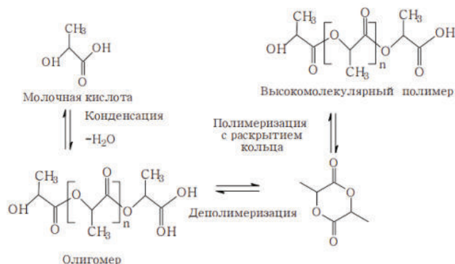
Рисунок 2 – Схема процесса конденсации [1]
