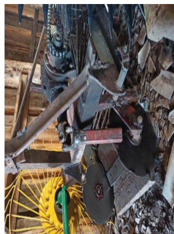
Рисунок 6 – Однорядный картофелекопатель с прутковым элеватором:
