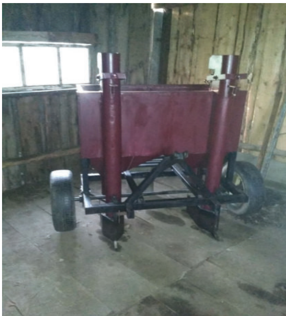
Рисунок 3 – Общий вид картофелесажалки: а – вид спереди, б – вид сбоку
