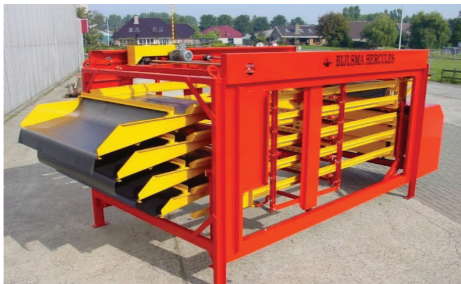
Рисунок 2 – Грохотное сортирующее устройство
