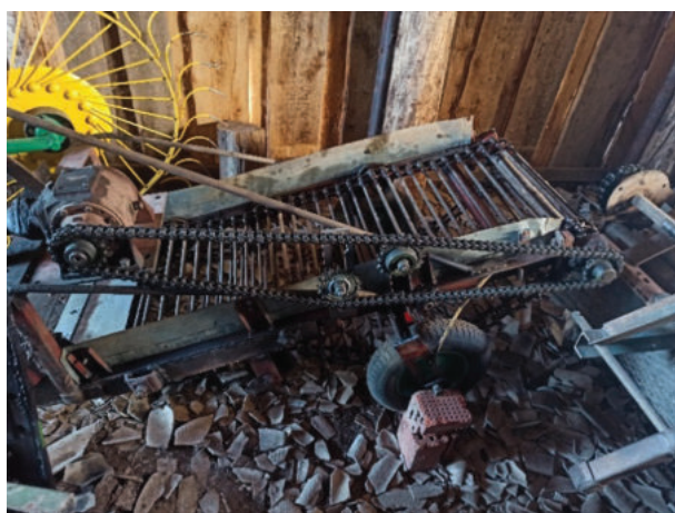
Рисунок 6 – Однорядный картофелекопатель с прутковым элеватором:
