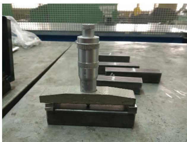
Рисунок 2 – Измерение изгиба микрометрическим глубиномером
