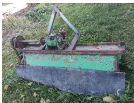
Рисунок 1 – Почвенная прицепная фреза: а – вид спереди; б – вид сзади
