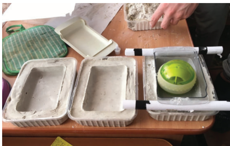
Рисунок 2 – Изготовление образцов звукоизоляции с содержанием костры 0 %, 20 % и 40 %
