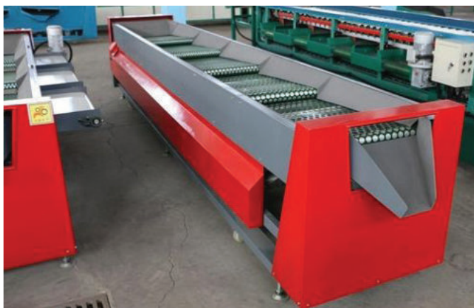
Рисунок 5 – Ленточные машины для калибровки овощей
