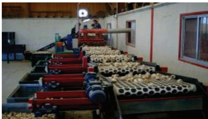
Рисунок 4 – Ленточное сортирующее устройство
