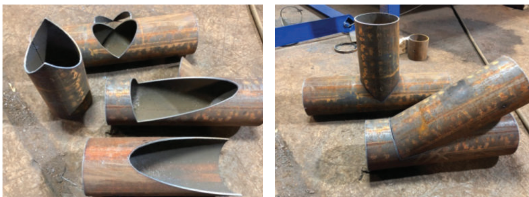
Рисунок 3 – Результаты фигурного реза круглой трубы
