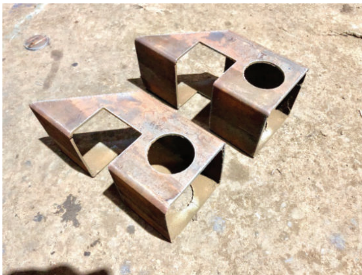
Рисунок 4 – Результаты фигурного реза квадратной трубы
