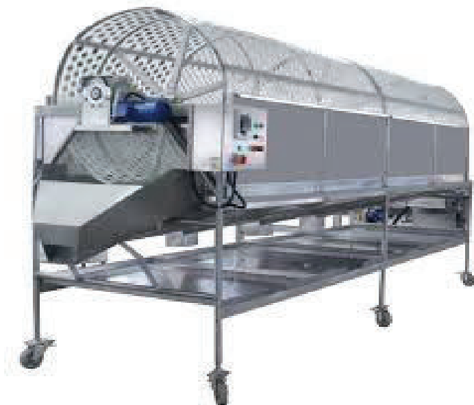
Рисунок 1 – Барабанное сортирующее устройство
