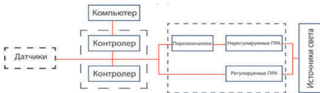
Рисунок 1 – Структурная схема автоматизированной системы управления освещением [15]
