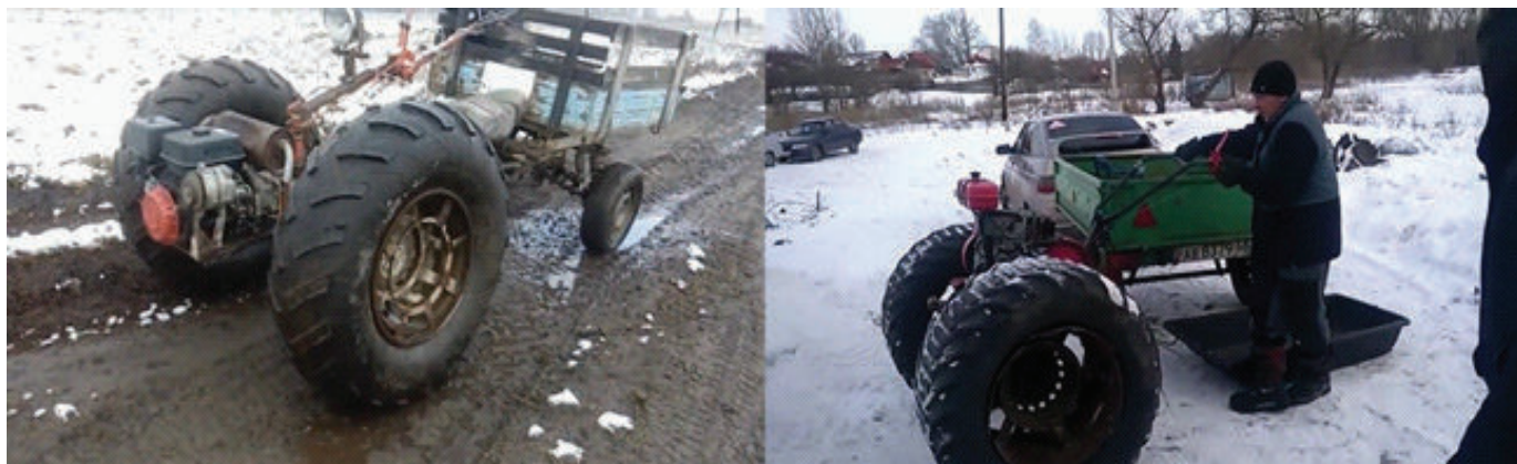
Рисунок 1 – Увеличение проходимости с помощью колес большего диаметра
