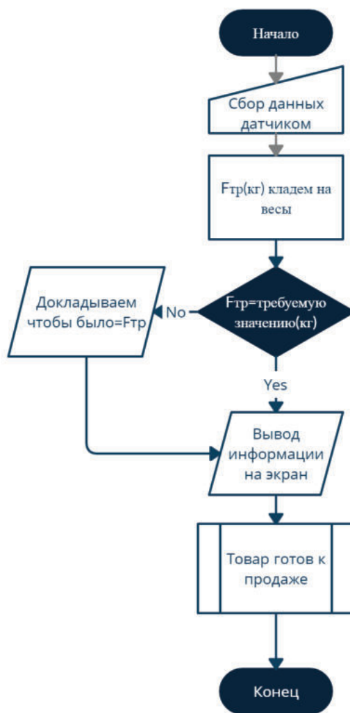
Рисунок 2 – Алгоритм взвешивания урожая в защищенном грунте
