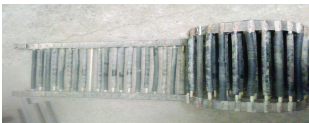
Рисунок 2 – Транспортер со стекловолоконными прутками
