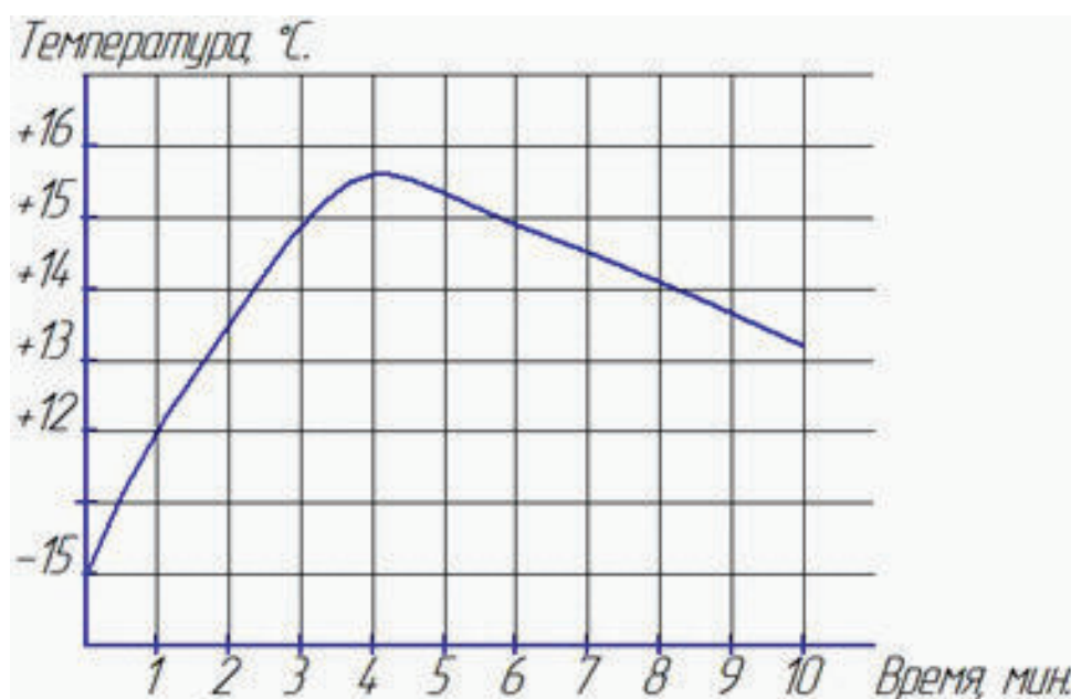
Рисунок 3 – График зависимости температуры охлаждающей жидкости в рубашке охлаждения двигателя от времени в процессе предпускового подогрева
