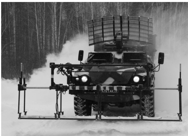
Рисунок 8 – Машина дистанционного разминирования «Листва»
