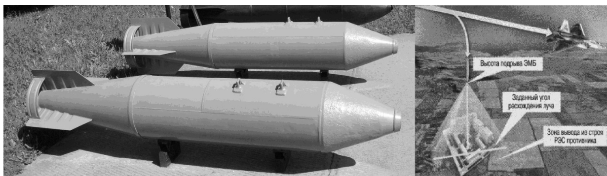
Рисунок 6 – Авиационные бомбы ЭМИ и схема их использования
