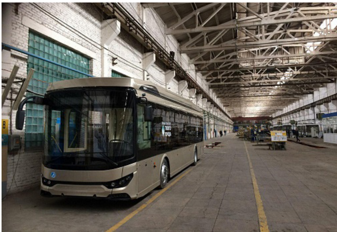
Рисунок 6 – Троллейбус с возможностью рекуперации электроэнергии в Ижевске
