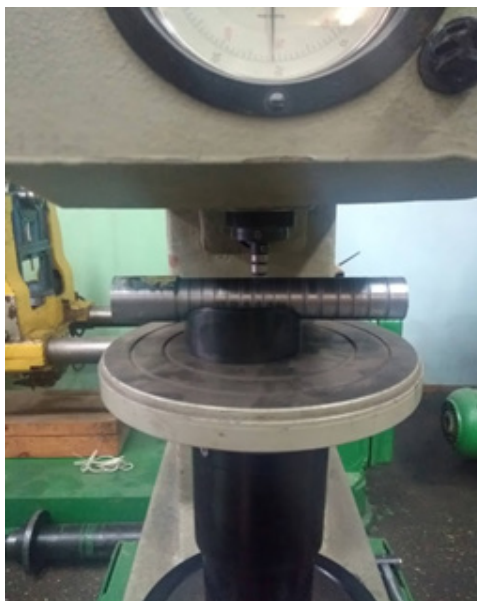
Рисунок 3 – Измерение твёрдости поверхности образцов
