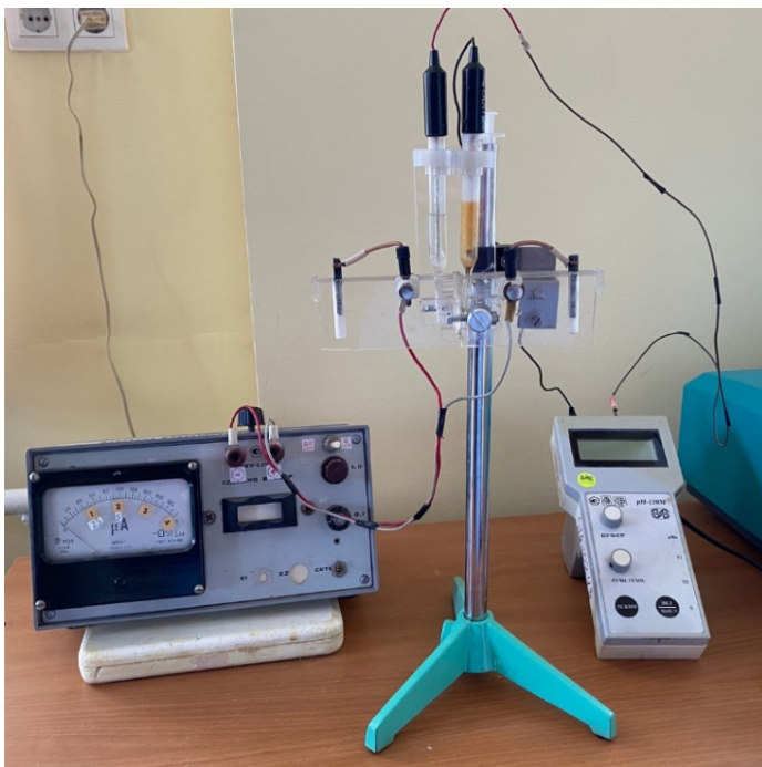
Рисунок 3 – Установка для измерения электропроводности кожи
