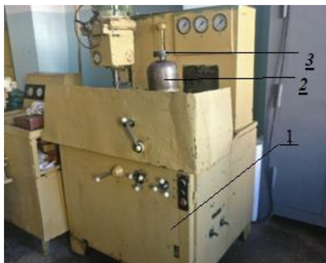
Рисунок 1 – Общий вид лабораторной установки: 1 – стенд КИ-28119; 2 – исследуемая центрифуга; 3 – вибрационный тахометр КИ-1308В
