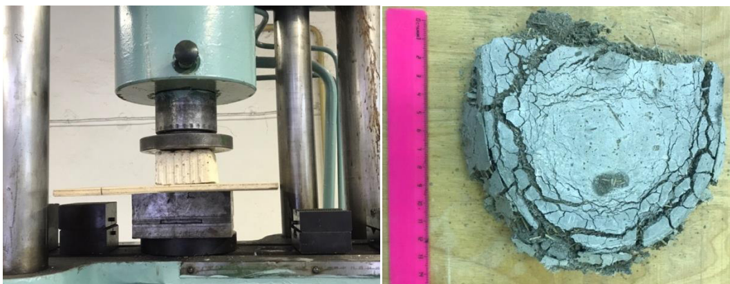
Рисунок 3 – Испытание лабораторного образца на машине УММ-50
