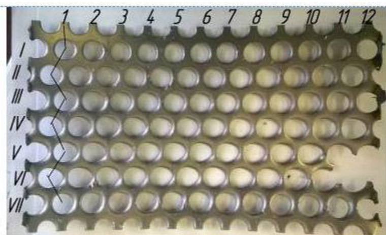
Рисунок 3 – Изношенное решето после измельчения 250 т зерна
