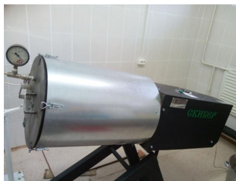
Рисунок 1 – Устройство (а) и общий вид (б) установки: 1 – крышка; 2 – барабан; 3 – нагревательный элемент (ТЭН); 4 – шнек; 5 – редуктор; 6 – электродвигатель; 7 – рама; 8 – манометр; 9 – вакуумный насос
