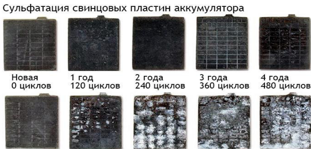
Рисунок 1 – Процесс сульфатации пластин АКБ в зависимости от срока эксплуатации и циклов заряда-разряда
