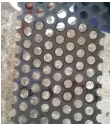
Рисунок 2 – Новое решето: диаметр отверстия 10 мм; площадь отверстия 78,5 мм 2
