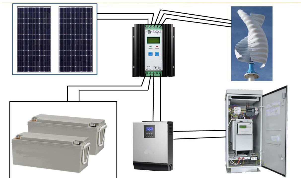
Рисунок 3 – Автономная станция катодной защиты
