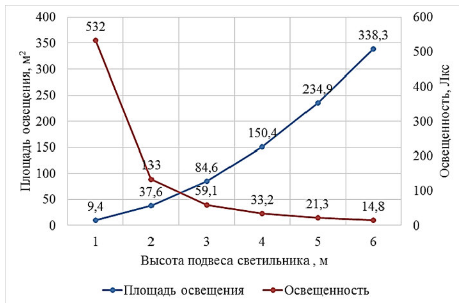
Рис. 4 – Зависимости уровней освещенности площади освещаемого помещения от высоты подвеса светильника
