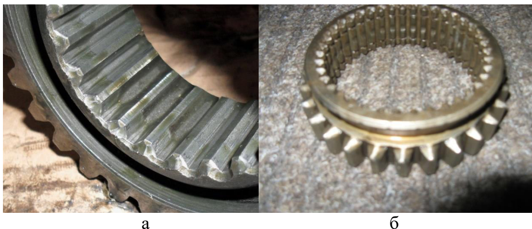
Рисунок 1 – Муфта переключения передач до (а [4]) и после (б) обработки на токарном станке
