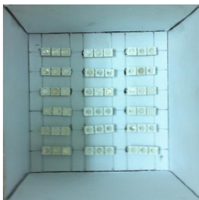
Рисунок 1 – Расположение светодиодов и общий вид светодиодной облучательной установки
