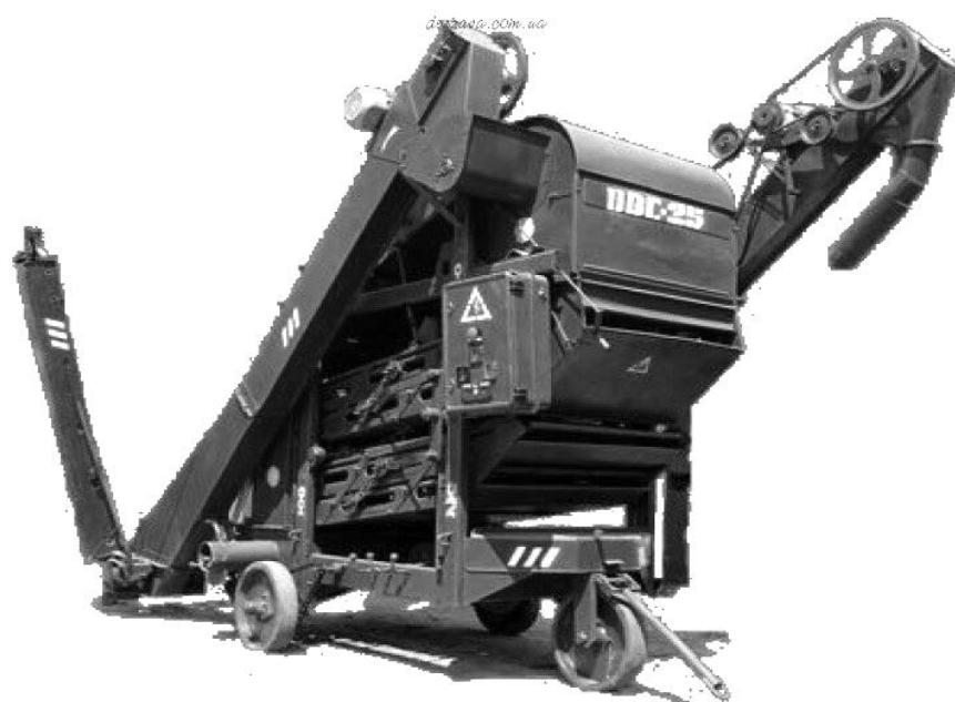
Рисунок 1 - Зерноочистительная машина ОВС-25
