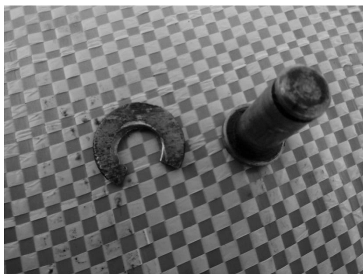
Рисунок 3 – Излом стопорной планки
